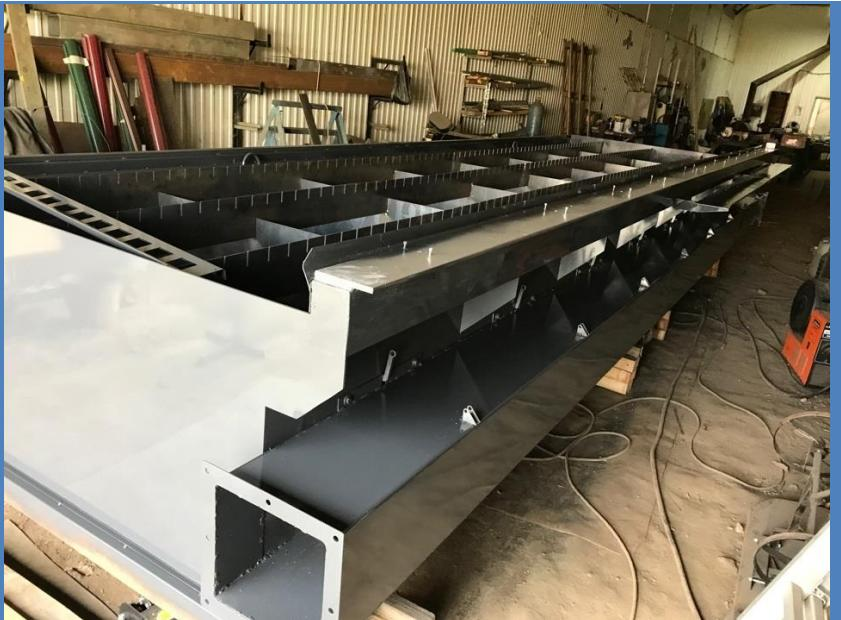
Стол обшил со всех сторон. Имеются специальные люки. В зависимости от комплектации станка подготовка к вентиляции либо отсутствует (бюджетный вариант) или выполнена система вытяжки в зоне реза, что многократно повышает производительность вытяжки. При обустройстве системы вентиляции оборудование должно иметь производительность не менее 6000 м.куб./час.
