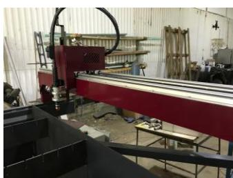
Установлены мощные двигатели с планетарными редукторами и **механизмом компенсации люфтов** в зубчато-реечной передачи. Все это повышает точность, динамичность работы оборудования и уменьшает время на обслуживание приводов. См фото.
