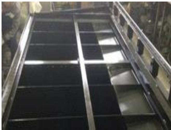
Многозонная система дымоудаления. Стол станка разбит на несколько зон. При движении портала специальные клапана открывают воздушные заслонки только там, где работает резак. В остальных зонах заслонки закрыты. Данная конструкция позволяет более продуктивно использовать вытяжную систему.
